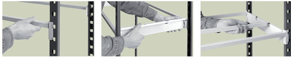
① Les tubes extérieurs (lisses) s'accrochent aux montants. ② Les traverses s'accrochent aux barreaux extérieurs et s'appuient sur les montants. ③ Les tubes intérieurs s'emboîtent sur les traverses.
